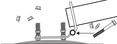
Отрегулируйте гайки, чтобы флагшток стоял ровно. Подтяните гайки по прошествии одного месяца.
