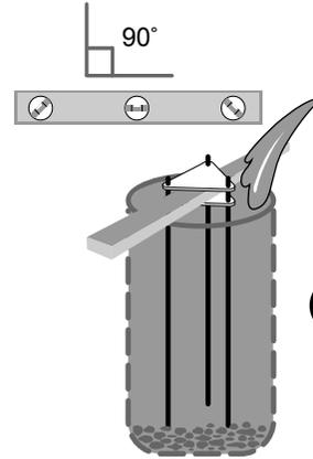
Установите крепление на плите на 2 см выше края отверстия. Залейте бетон.
